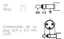
Conexionado de un plug 6.3 mm (1/4") no balanceado
